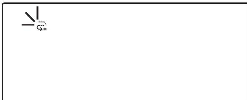
Se si usano le funzioni Vapore per oltre 12 ore, la spia Anticalcare si accende. E' possibile attivare la funzione vapore per le due ore successive senza passare dalla funzione anticalcare. Tuttavia, nessuna funzione a vapore verrà attivata dopo due ore a meno che non venga attivato e completato un ciclo di decalcificazione.
