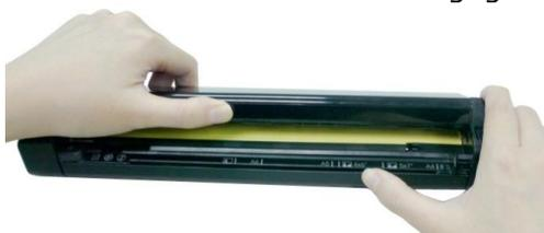
2. Essuyez doucement la vitre et les rouleaux du scanner ainsi que la protection du capteur d'images par contacts (CIS) avec un chiffon de nettoyage (*inclus*).
