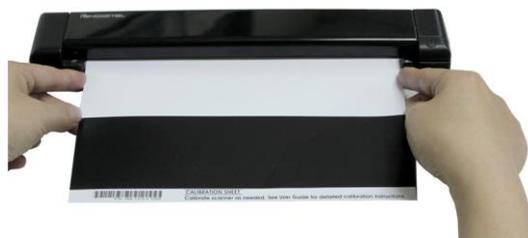
9. Cliquez sur **OK** dans la boîte de dialogue **Insert calibration sheet** (Insérer la feuille de calibrage) pour commencer à calibrer le scanner.
