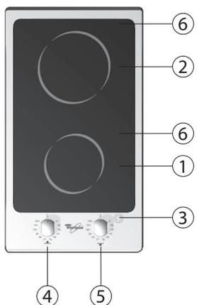
1. Zona di cottura radiante Ø 145
