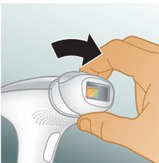
Para remover o acessório, puxe-o para desencaixá-lo da janela de saída da luz.
