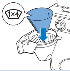
**4** Nehmen Sie eine Papierfiltertüte (Typ 1x4 oder Nr. 4), und falten Sie die gestanzten Ränder um, damit die Filtertüte während des Brühvorgangs nicht reißt oder einknickt. Setzen Sie die Filtertüte in den Filterhalter.
