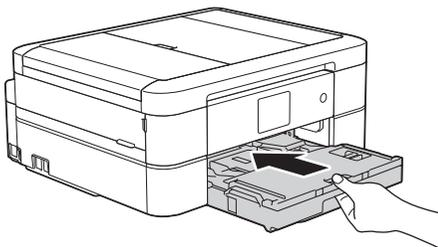
**10** Tout en maintenant le bac à papier dans l'appareil, tirez le support papier (1) jusqu'à ce qu'il se mette en place, puis déployez le volet du support papier (2).
