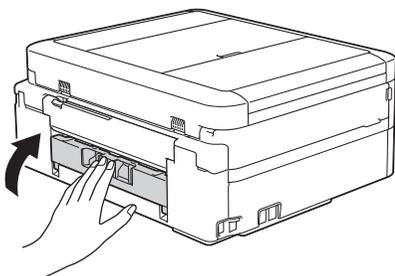
**9** Remettez fermement le bac à papier dans l'appareil.
