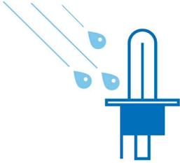
Solo una lámpara encendida fabricada con cristal de cuarzo (filamento a 2650 °C, cristal a 800 °C) puede soportar cambios bruscos de temperatura; por ejemplo, resiste sin explotar el goteo de agua fría sobre el cristal caliente de la lámpara,
