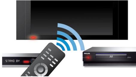
O EasyLink permite-lhe controlar vários dispositivos, como leitores de DVD, leitores Blu-ray, altifalante Soundbar, sistema de cinema em casa, televisores, etc., com um telecomando. Este utiliza o protocolo padrão da indústria, HDMI CEC, para partilhar funcionalidades entre dispositivos através do cabo HDMI. Com o toque de um botão, pode operar simultaneamente todos os equipamentos HDMI CEC ligados. Funções como o modo de espera e a reprodução podem agora ser aplicadas com total facilidade.
