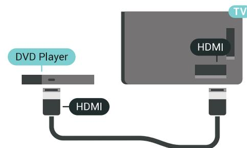
Wenn der DVD-Player über HDMI angeschlossen ist und über **EasyLink CEC** verfügt, können Sie den Player mit der Fernbedienung des Fernsehers steuern.
