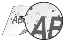
Tonerflekker og sprut vises
