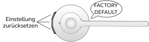
Die Basisstation wird neu gestartet, und die Einstellungen werden auf die Werkseinstellungen zurückgesetzt. Dieser Vorgang wird durch das weiße Akkusymbol
