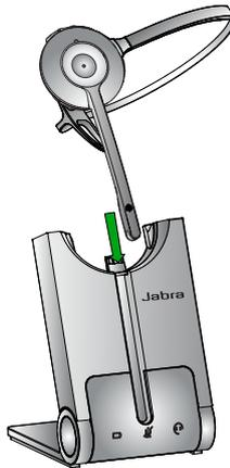
Docken Sie das Headset an. Ist das Headset korrekt andocked, wird der Headset-Akku geladen, falls dies erforderlich ist. Der Ladevorgang dauert 20 Minuten oder bis die Akkuanzeige an der Basis
