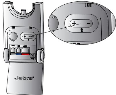
**Hinweis:** Hinweis Um die Mikrofonlautstärke auf die Werkseinstellungen zurückzusetzen, tätigen Sie einen Anruf. Dann drücken Sie gleichzeitig beide Lautstärketasten des Mikrofons (+/-) und halten Sie sie gedrückt, bis ein akustisches Signal ausgegeben wird. Lassen Sie die Lautstärketasten dann los.
