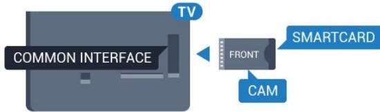
Stecken Sie die CAM-Karte in den Common Interface-Steckplatz des Fernsehers.
