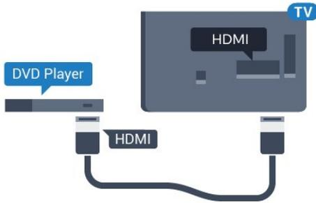
Wenn der DVD-Player über HDMI angeschlossen ist und über EasyLink CEC verfügt, können Sie den Player mit der Fernbedienung des Fernsehers steuern.
