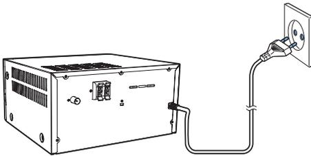
Verbinden Sie das Netzkabel mit einer Steckdose.
