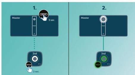
Установка без роутера, пароля и приложений. Просто удерживайте кнопку GROUP на обеих АС при первоначальной настройке. Повторите действие для добавления третьей, четвертой и пятой АС. При каждом долгом нажатии кнопки Group
