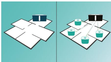
Беспроводная технология izzylink™ использует стандарт IEEE 802.11n для объединения нескольких АС и создания беспроводной сети, к которой можно подключить до пяти систем без использования роутера, пароля Wi-Fi или мобильного приложения на смарт-устройстве. Вы сможете наслаждаться музыкой одновременно в разных комнатах, добавив АС izzy в сеть. Простым нажатием кнопки выбирайте для каждой АС режим индивидуального воспроизведения или режим группы для прослушивания музыки сразу в нескольких комнатах.
