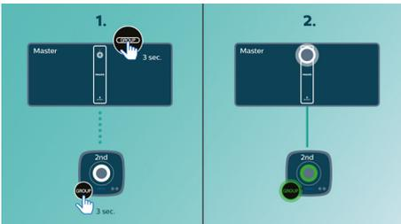
La configuration ne nécessite ni routeur, ni mot de passe. Une pression longue sur le bouton « GROUP » de deux enceintes vous permet de réaliser la configuration initiale. Répétez l'opération pour
