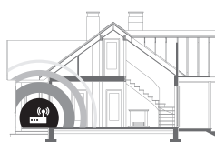
Posición no adecuada del enrutador
