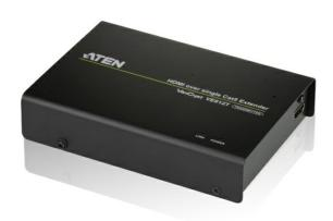
O Transmissor HDMI através de um único cabo Cat 5 VE812T suporta a tecnologia HDBaseT que utiliza um único cabo Cat 5e para aumentar o alcance dos sinais até 100 m. O VE812T suporta HDMI (3D, Deep Color), assim como, Ultra HD (4k) e é compatível com HDCP. Além disso, a passagem remota de EDID garante uma ótima qualidade de vídeo para o seu monitor HDMI.
