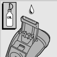
**3** ทุกๆ หกเดือน ควรหยดน้ำมันจักรเพื่อหล่อลื่นซี่ฟันของที่กันจอน
