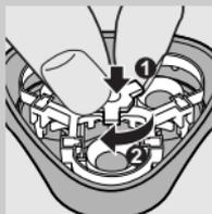
**5** Letakkan balik rangka penahan ke dalam unit pencukur (1) dan putar rodanya ikut arah jam (2).
