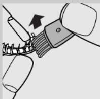
**5** 用毛刷的短毛一侧清洁刀片。按箭头方向仔细刷净刀片。
