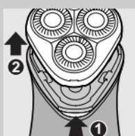
**1** ปิดสวิตช์เครื่องโกนหนวด ถอดปลั๊กไฟออกจากเต้ารับ และถอดปลั๊กเครื่องโกนหนวดออกจากตัวเครื่อง
