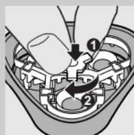
**5** 将固定架放回剃须刀头部件 (1)，并按顺时针方向转动轮轴 (2)。
