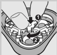
**7** 将剃须刀头重新安装到剃须刀头部件上，将固定架放回剃须刀头部件 (1)，并按顺时针方向转动轮轴 (2)。
