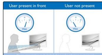
O PowerSensor é um "sensor humano" incorporado que transmite e recebe sinais infravermelhos inofensivos para determinar a presença do utilizador e reduzir automaticamente o brilho do monitor quando o utilizador se afasta da secretária, reduzindo os custos de energia em até 80% e prolongando a vida útil do monitor.
