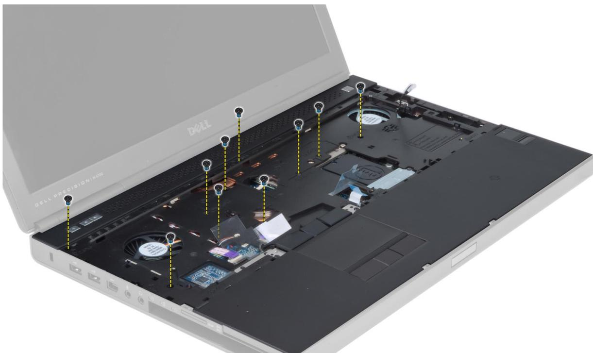
12. Soulevez le bord gauche du repose-mains. Dégagez les languettes sur le bord droit du repose-mains et retirez ce dernier de l'ordinateur.
