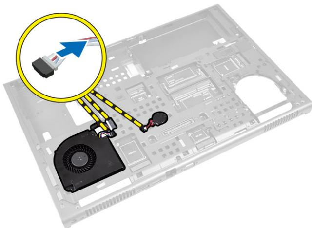
4. Déconnectez le câble du connecteur d'alimentation. Retirez les vis fixant la carte système à l'ordinateur et soulevez le bord inférieur de la carte système en l'inclinant selon un angle de 20 degrés.
