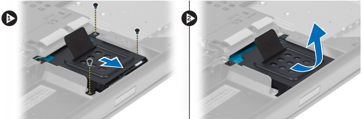
5. Retirez la vis fixant le disque dur secondaire au support.
