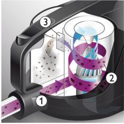
采用空气动力学设计的第七代飓风离尘技术通过 3 个高效步骤，减少空气阻力并确保非凡的清洁性能：1)得益于笔直平滑的进风口，空气可以快速地进入飓风离尘。2)弧形通气道使空气加速上升空气旋室。3)在旋风过滤器的顶部，出口叶片可以高效地使灰尘与空气分离。
