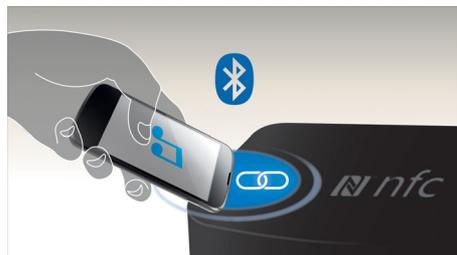
使用一触式 NFC (近场通信) 技术轻松配对蓝牙设备。只需用 NFC 智能手机或平板电脑轻触扬声器的 NFC 区域打开扬声器, 便可启动蓝牙配对并开始传输音乐。
