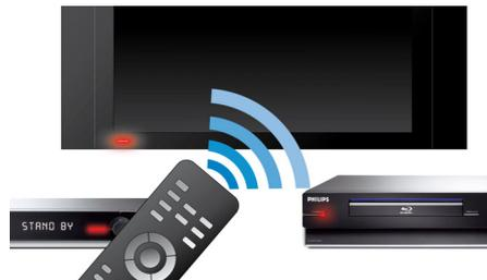
EasyLink 让您可以通过一个遥控器控制 DVD 播放机、蓝光光盘播放机、平板影院扬声器、家庭影院和电视等多台设备。它使用 HDMI CEC 行业标准协议, 并通过 HDMI 连接线在设备之间共享功能。只需轻触按钮, 您就可以同时操控支持 HDMI CEC 的所有连接设备。待机和播放等功能尽在您的掌握之中。
