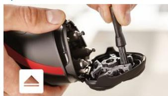
Basta aprire le testine e utilizzare la spazzolina per la pulizia in dotazione per rimuovere i residui di rasatura.
