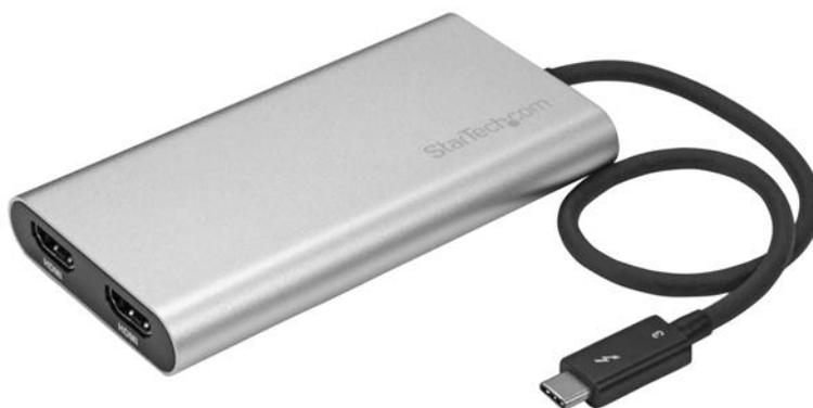
Este adaptador Thunderbolt™ 3 de alto rendimiento le permite agregar dos monitores HDMI 4K a un ordenador a través de un solo puerto Thunderbolt 3 (USB-C™). El adaptador de vídeo Thunderbolt es compatible con los sistemas informáticos que admiten Thunderbolt 3, como los modelos de Dell™ Precision y Dell XPS.
