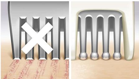
Die abgerundeten Trimmerspitzen vor und hinter der Scherfolie sorgen dafür, dass der Rasierer sanft über Ihre Haut gleitet, und verhindern Kratzer für eine hautschonende Rasur.
