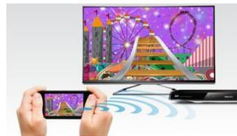
Miracast™ 是一種透過 Wi-Fi Direct 連線所建立的點對點影像錄製標準。簡化的使用者介面方便您將可攜式裝置畫面透過 Miracast™ 認證裝置，以鏡射方式在較大螢幕上播放，且不會受到預先建立的轉碼器解碼限制。
