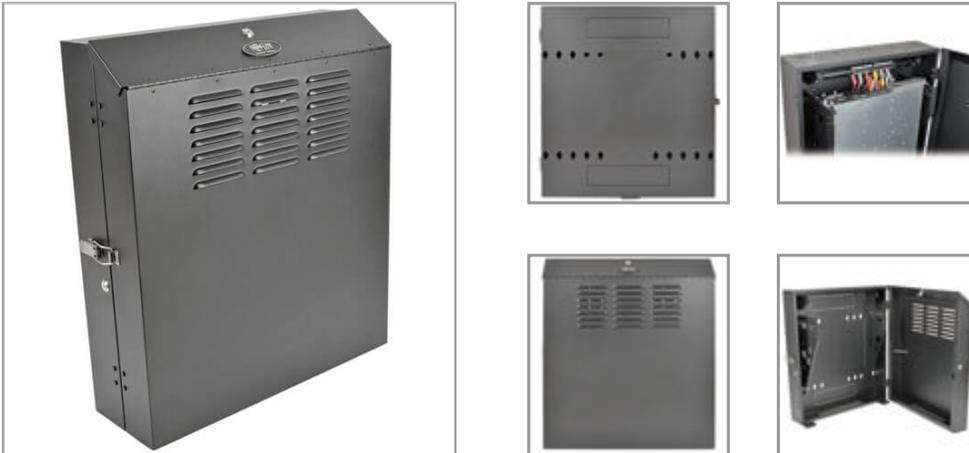
El gabinete para instalación en pared asegura y organiza 4U de rack de 19" en gabinetes de cableado de redes y otras ubicaciones con espacio de piso limitado. Aloja equipo de hasta 0.5 m [20"] de profundidad, pero se proyecta solo 20.3 cm [8"] de la pared.
