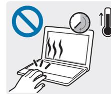
**No toque las ranuras de ventilación del ordenador(computador) ni el adaptador de corriente conectado durante mucho tiempo mientras el ordenador(computador) está encendido.**
