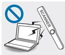
**Evite exponer las unidades a campos magnéticos. Entre los dispositivos de seguridad con campos magnéticos se incluyen los arcos de seguridad de los aeropuertos y los detectores de seguridad. Los dispositivos de seguridad de los aeropuertos utilizados para el control de las maletas de mano, como las cintas transportadoras, utilizan rayos X en lugar de magnetismo, y no dañarán las unidades.**
