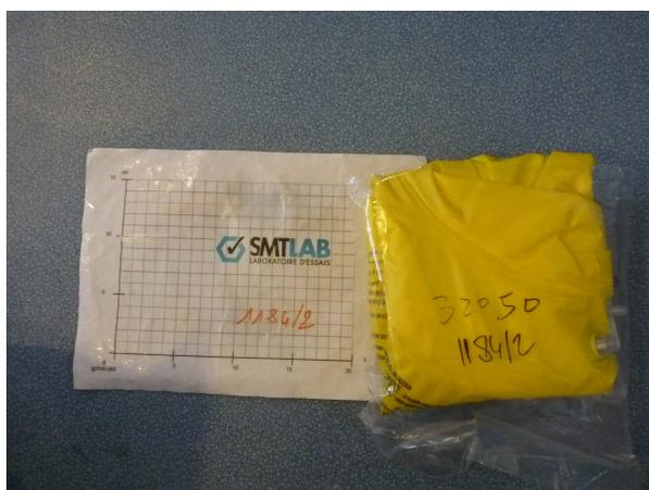
**NF EN ISO 105 E04 09-1996 Résistance teinture à la sueur Pression : 12,5 kPa Temps : 4 heures Température : 37C° +/- 2C°, Témoin multifibre DW A2** Réalisé le 20/05/15 - Ver. 1
