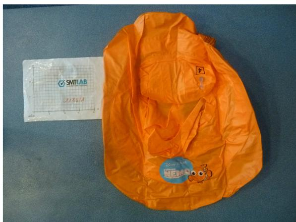
**NF EN ISO 105 E04 09-1996 Résistance teinture à la sueur Pression : 12,5 kPa Temps : 4 heures Température : 37C° +/- 2C°, Témoin multifibre DW A1** Réalisé le 20/05/15 - Ver. 1
