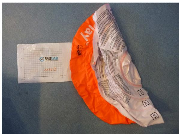
**NF EN ISO 105 E04 09-1996 Résistance teinture à la sueur Pression : 12,5 kPa Temps : 4 heures Température : 37C° +/- 2C°, Témoin multifibre DW A3** Réalisé le 20/05/15 - Ver. 1
