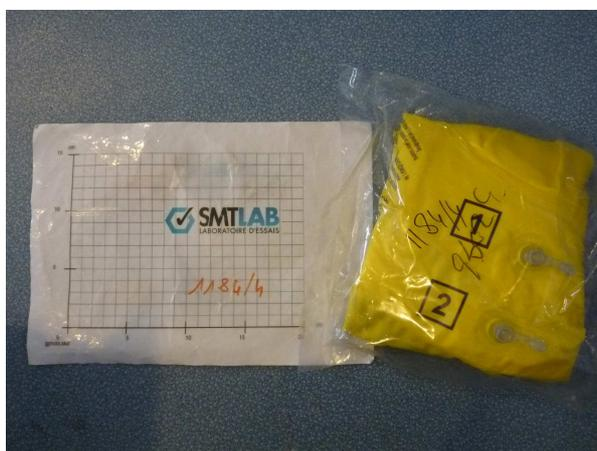
**NF EN ISO 105 E04 09-1996 Résistance teinture à la sueur Pression : 12,5 kPa Temps : 4 heures Température : 37C° +/- 2C°, Témoin multifibre DW A4** Réalisé le 20/05/15 - Ver. 1
