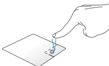
Zum Öffnen des Rechtsklickmenüs diese Schaltfläche antippen.
