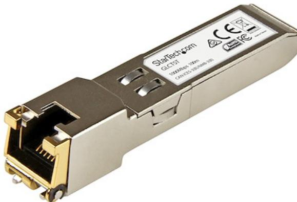
Le modèle GLCTST est un module de transceiver en cuivre compatible avec Cisco GLC-T, qui a été conçu, programmé et testé pour fonctionner avec les commutateurs et routeurs de la marque Cisco®. Il fournit une connectivité 1 GbE fiable sur câble en cuivre pour les réseaux conformes aux spécifications 1000BASE-T, avec une distance maximale de 100 m.
