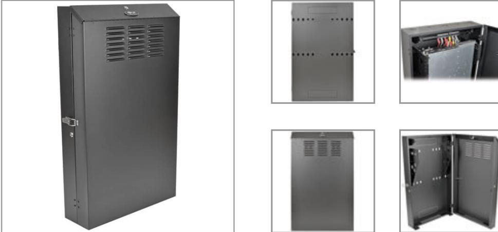
Der wandmontierte Schrank sichert und organisiert 4-HE 19-Zoll-rack Geräte in Netzwerkverkabelung Schränken und anderen Bereichen mit begrenzter Grundfläche. Für Geräte mit einer Tiefe bis zu 36 Zoll, aber steht nur 20 cm von der Wand ab.
