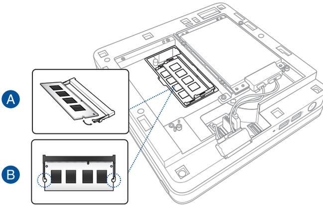
5. Riposizionate la cover dello slot SO-DIMM.
