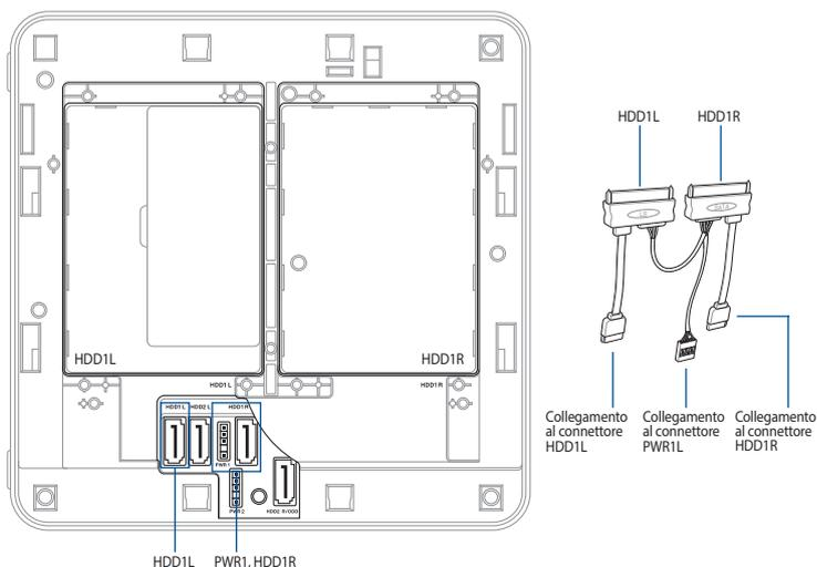
9. Collegate il cavo all'HDD/SSD quindi allineate la slitta all'alloggiamento HDD/SSD del vostro VivoMini e fissatela con le viti rimosse in precedenza.
