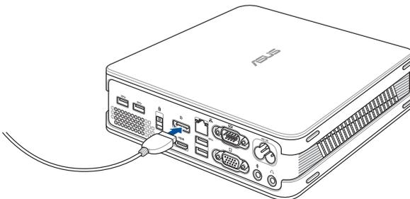
Collegamento tramite la porta VGA
