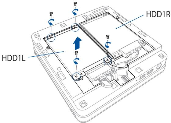
6. (opzionale) Per sostituire un HDD/SSD presente prima rimuovete le quattro (4) viti che fissano la slitta allo chassis quindi rimuovete l'HDD/SSD dalla slitta.
