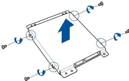
7. Installate il nuovo HDD/SSD alla slitta usando quattro (4) viti in dotazione.
