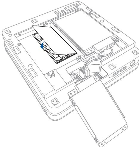
6. Allineate la slitta HDD1L e fissatela usando le viti rimosse in precedenza.
