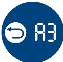
Grazie alla tecnologia avanzata AeraSense, la durata del filtro viene accuratamente calcolata in base al livello di inquinamento interno, al flusso d'aria e al tempo di funzionamento. L'avviso di protezione aria sana consente di sapere con anticipo quando è il momento di sostituire il filtro. Se il filtro non viene sostituito tempestivamente, l'apparecchio si arresta per evitare di funzionare senza che il filtro sia efficace. In questo modo hai la certezza di respirare sempre un'aria sana.
