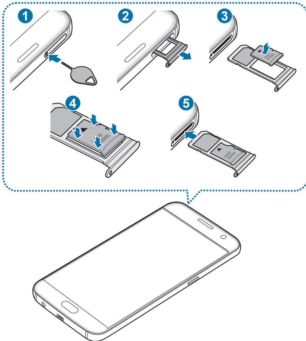
**1** Inserite lo strumento metallico nella fessura per estrarre il supporto.
