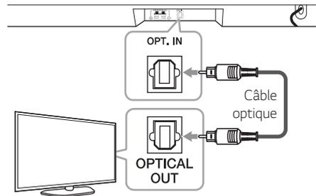
2. Appuyez plusieurs fois sur la touche **F** jusqu'à ce que la source d'entrée optique (OPTICAL) soit sélectionnée.
