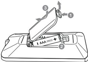
Retirez le couvercle du compartiment des piles à l'arrière de la télécommande, puis insérez les piles en respectant la polarité **+** et **-**.
