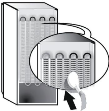
Per garantire il deflusso costante e corretto dell'acqua di sbrinamento, pulire regolarmente l'interno del foro di scarico situato sulla parete posteriore del comparto frigorifero in prossimità del cassetto frutta e verdura, usando l'utensile in dotazione.
