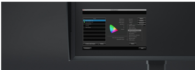
Der ColorNavigator speichert die Kalibrierung direkt in der in Look-Up-Table des Monitors.
