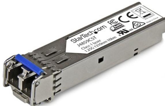
El modelo J4859CST es un módulo transceptor por fibra óptica, compatible con el modelo J4859C de HP, diseñado, programado y probado para su funcionamiento con enrutadores y conmutadores de la marca HP®. Ofrece conectividad fiable a 1GbE a través de cableado de fibra, para redes compatibles con 1000BASE-LX, a una distancia máxima de hasta 10km.
