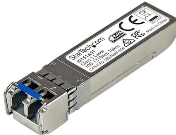
Le modèle J9151AST est un module de transceiver à fibre optique compatible avec HPE J9151A, qui a été conçu, programmé et testé pour fonctionner avec les commutateurs et routeurs de la marque HPE®. Il fournit une connectivité 10 GbE fiable sur câble à fibre optique pour les réseaux conformes aux spécifications 10GBASE-LR, avec une distance maximale de 10 km.
