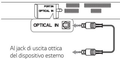
1. Collega la presa OPTICAL IN sul retro dell'unità alla presa di uscita ottica sulla TV (o su un dispositivo digitale).
