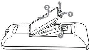
Togliere il coperchio delle batterie situato sul retro del telecomando e inserire due batterie R03 (misura AAA) allineando correttamente i poli + e -.
