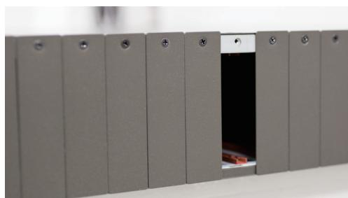
**Paso 3:** Coloque la placa del convertidor multimedia en la bahía del chasis disponible y asegúrela utilizando el tornillo de presión del panel frontal del convertidor.
