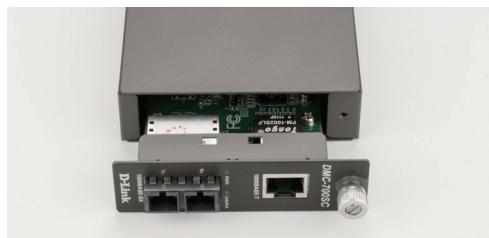
**Passo 2:** Svitare e rimuovere la copertura di uno qualsiasi degli slot vuoti sul telaio.
