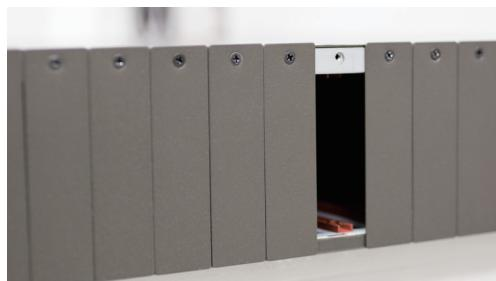
**Schritt 3:** Setzen Sie die Medienkonverterplatine in den freien Gehäusesteckplatz ein und sichern Sie sie mithilfe der Flügelschraube auf der Vorderseite des Konverters.
