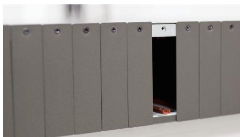
**Étape 3 :** Placez la carte du convertisseur de médias dans le slot vide du châssis et fixez-la en utilisant la vis à tête de violon sur la face avant du convertisseur.
