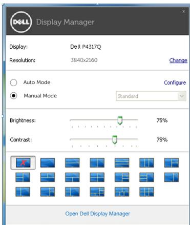
El cuadro de dialogo Configuración rápida también proporciona acceso a la interfaz de usuario avanzada de Dell Display Manager, que se utiliza para ajustar funciones básica, configurar el modo automático y acceder a otras funciones.
