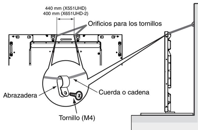
Antes de fijar el monitor LCD a la pared, asegúrese de que ésta puede soportar el peso del monitor.
