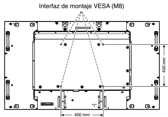
Los accesorios adicionales se pueden colocar con el monitor boca abajo. Para evitar dañar la superficie de la pantalla, coloque la lámina protectora en la mesa debajo del LCD. La lámina protectora envuelve el LCD en el embalaje original. Asegúrese de que no hay nada en la mesa que pueda dañar el monitor.
