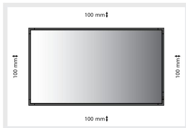
Permita que haya una ventilación adecuada o aire acondicionado alrededor del monitor, de tal forma que el calor se pueda disipar adecuadamente de la unidad y de los aparatos adicionales, sobre todo si utiliza monitores en varias pantallas.
