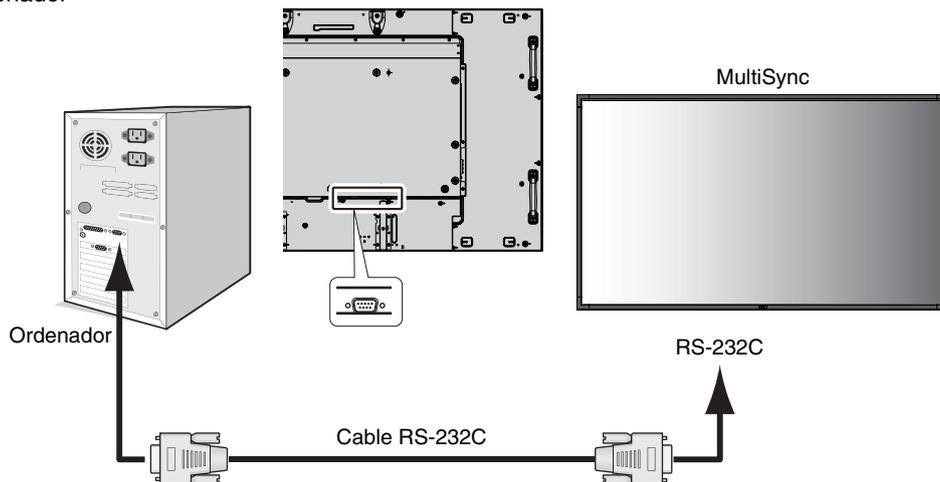
**NOTA:** Si su ordenador sólo tiene un conector de puerto serie de 25 clavijas, es necesario un adaptador de puerto serie de 25 clavijas. Póngase en contacto con su distribuidor si desea más información. Para ver la asignación de las clavijas consulte "2) Entrada/salida RS-232C" abajo.
