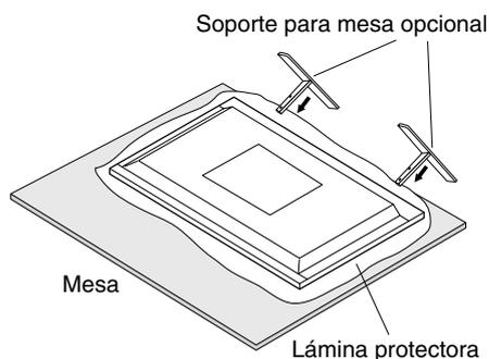
**NOTA:** Para el modelo X551UHD, use el ST-5220. Instale el soporte procurando que el extremo largo de los pies mire hacia delante. Para el modelo X651UHD-2, use el ST-651. Instale el soporte según la dirección que indica la flecha que está impresa en la superficie del soporte.
