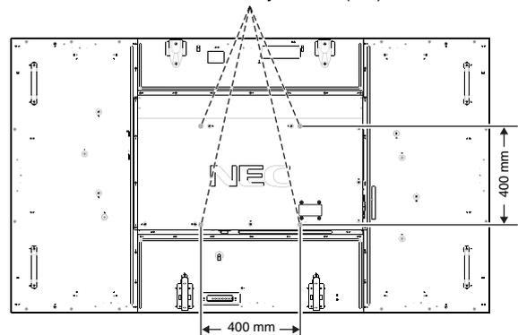
Los accesorios adicionales se pueden colocar con el monitor boca abajo. Para evitar dañar la superficie de la pantalla, coloque la lámina protectora en la mesa debajo del LCD. La lámina protectora envuelve el LCD en el embalaje original. Asegúrese de que no hay nada en la mesa que pueda dañar el monitor.
