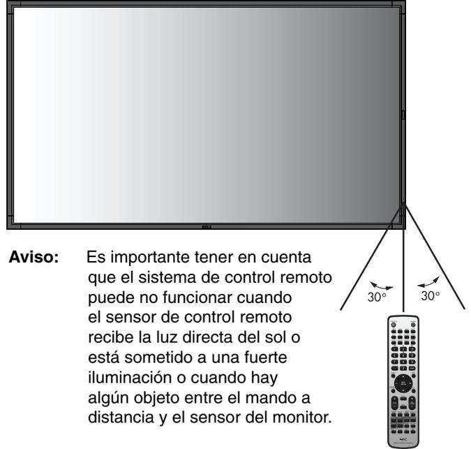
**Aviso:** Es importante tener en cuenta que el sistema de control remoto puede no funcionar cuando el sensor de control remoto recibe la luz directa del sol o está sometido a una fuerte iluminación o cuando hay algún objeto entre el mando a distancia y el sensor del monitor.
