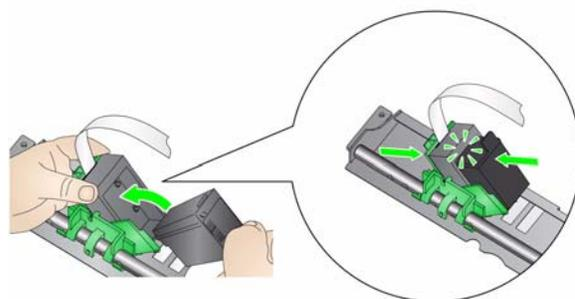
22. Ruotare il supporto della stampante verso l'alto e inserire la cartuccia di inchiostro in posizione.
