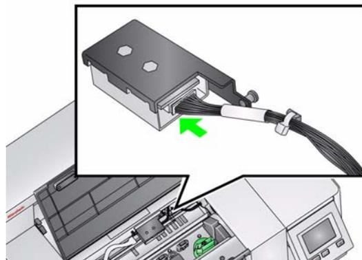
16. Fissare il supporto della stampante di tipo avanzato sul supporto verde come indicato di seguito.
