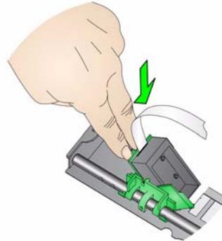
21. Setzen Sie die Tintenpatrone, wie in der Abbildung dargestellt, ein und lassen sie einrasten.
