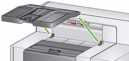
13. Öffnen Sie die Druckerzugangsklappe und entfernen Sie die Druckerabdeckung.
