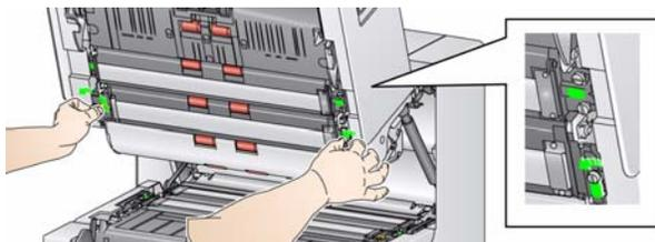
3. Setzen Sie die Imaging-Führung des Enhanced Printer ein und sichern Sie diese mit den beiden Schrauben. *Überdrehen Sie sie nicht.*
