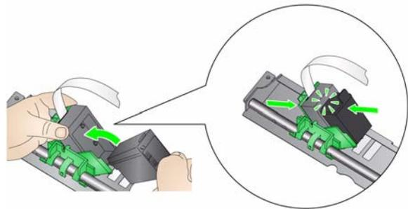
22. Drehen Sie den Druckerhalter nach oben und bis die Tintenpatrone einrastet.
