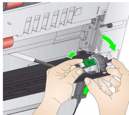
6. Installieren Sie den drehbaren Hintergrund. Schließen Sie hierzu das Kabel an und richten Sie die Federn am des drehbaren Hintergrunds aus. Ziehen Sie die Schrauben wieder fest. *Überdrehen Sie sie nicht.*
