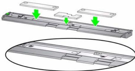
10. Setzen Sie den Drainagestreifen an die Stelle des schwarzen Streifens ein, der in Schritt 8 entfernt wurde.
