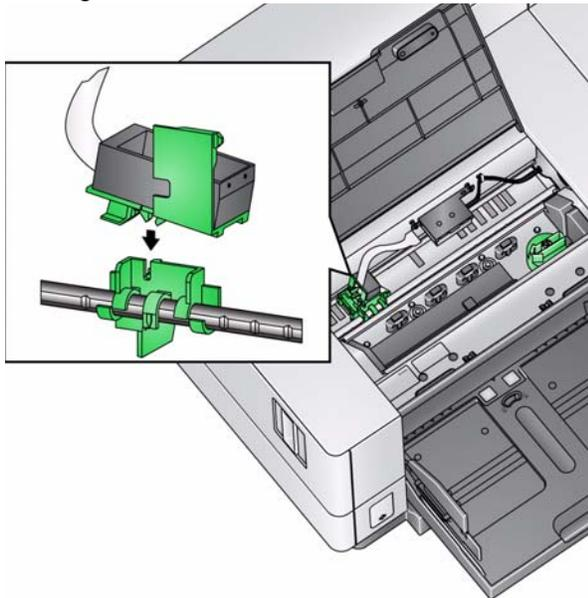
17. Schließen Sie das Drucker Kabel vom Druckerhalter an der linken Seite des Leiterplatten-Zubehöerteils an. Achten Sie darauf, dass die Kupferseite des Druckerkabels nach unten zeigt.
