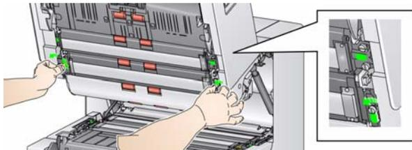
3. Instale la guía de imagen de la impresora mejorada y apriete los tornillos para asegurar dicha guía de imagen. *No los apriete demasiado.*
