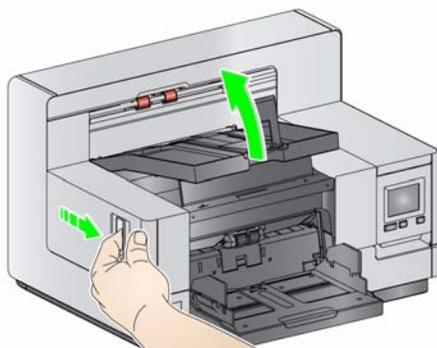
2. Afloje los tornillos de ajuste manual que se encuentran en cada extremo de la guía de imagen superior y extráigala de su posición.
