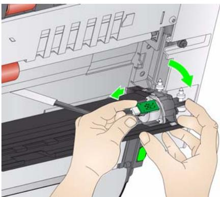
6. Conecte el cable y alinee los muelles con el extremo del fondo giratorio para instalarlo. Apriete los tornillos de ajuste manual en su lugar correspondiente. *No los apriete demasiado.*
