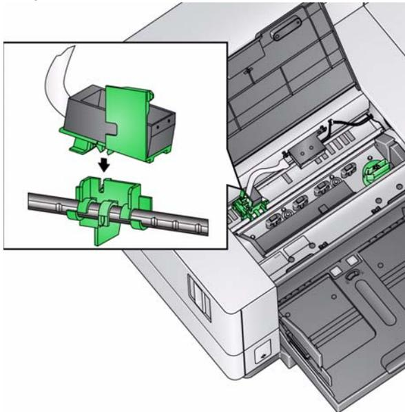
17. Conecte el cable de la impresora desde el portacartuchos hacia el lado izquierdo de la placa de circuito impreso. Asegúrese de que el lado de cobre del cable de la impresora mira hacia abajo.
