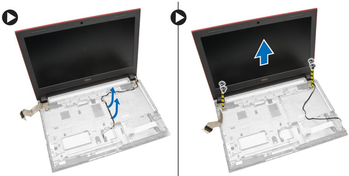
4. 将显示屏面板放置在平稳的表面上，然后将挡板提离计算机。
