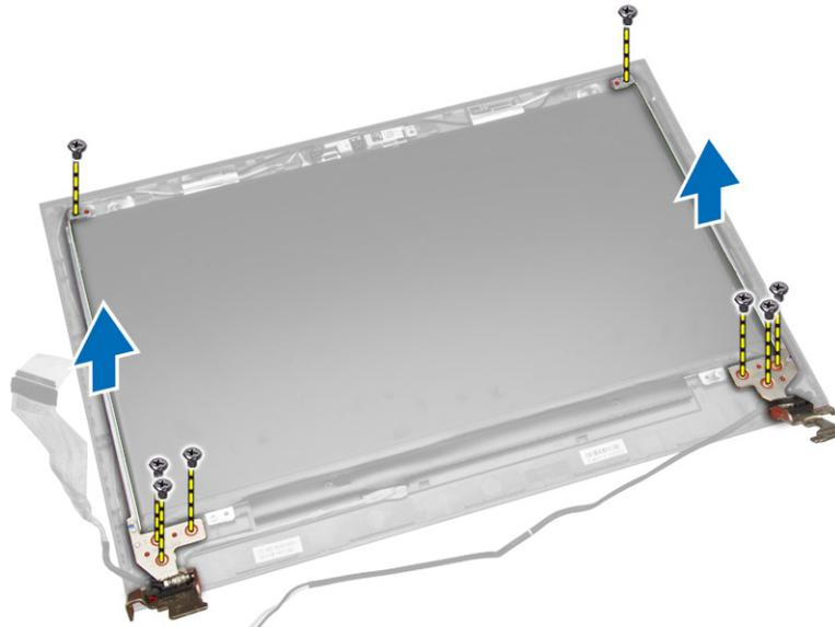
6. 拧下将显示屏面板固定至显示屏部件的螺钉。然后翻转显示屏面板，以便能够操作下面的电缆。
