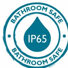
Rigorosamente testata per assicurare la resistenza all'acqua, questa luce per il bagno Philips è appositamente ideata per gli ambienti umidi. Il livello IP è indicato da due cifre: la prima fa riferimento al livello di protezione contro la polvere, mentre la seconda alla protezione contro l'acqua. Questa lampada per il bagno è stata progettata con IP65: ideale per l'uso sotto la doccia.
